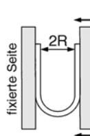
Biegen Sie den Schlauch bei einer Temperatur von 20°C in U-Form. Fixieren Sie eine Seite und schliessen Sie schrittweise die Schlinge. Messen Sie den Wert 2R, wenn der Schlauch bricht oder gequetscht wird.
